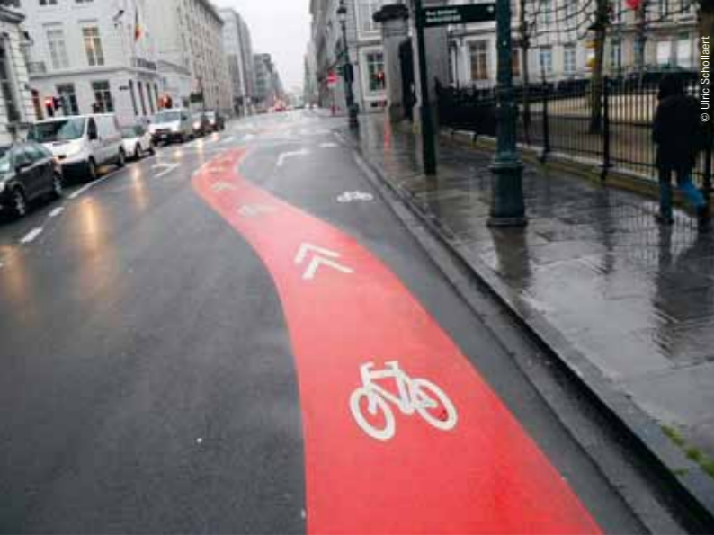
Kreuzung Rue de la Loi: Pkws müssen rechts oder links abbiegen – nur RadfahrerInnen dürfen geradeaus fahren, und zwar in eine Fahrbahn, wo Radfahren gegen die Einbahn gestattet ist.
