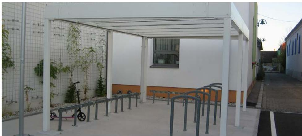
Abbildung 23: Kombinierte Abstellanlage mit Fahrradbügeln und Scooter-Plätzen mit Witterungsschutz und Fassadenbegrünung in Pfaffstätten, Bild: Tadej Brezina
